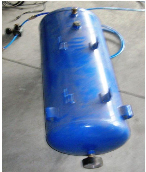
Bombola Aria con manometro e valvola di sicurezza a norma
